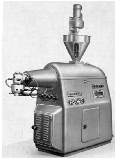
Extruder zur Herstellung von Formstücken aus thermoplastischem Material, das im formbaren Zustand durch Düsen gepresst wird (12)
